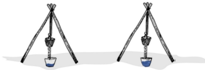
شکل ۶: دو سفال آویزان از سه پایه، آزمایشی برای یافتن آب خالص تر (طرح از سمسار یزدی و لباف خانیکی ۲۰۱۷).
